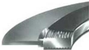
Innovation en matière d'étanchéité métallique, le joint strié est constitué d'un corps métallique usiné, présentant des rainures concentriques et le cas échéant d'un recouvrement en PTFE, graphite, argent ou aluminium. Le joint strié présente plusieurs atouts parmi lesquels, une étanchéité assurée à faible serrage : Min 20N/mm<sup>2</sup> (spiralé : min 50 N/mm<sup>2</sup>), un montage et une manutention facile et permissive et une forte résistance aux variations de température et de pression.
